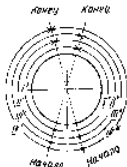
Рис. V-17. Схема наложения слоев шва при ручной электродуговой сварке
